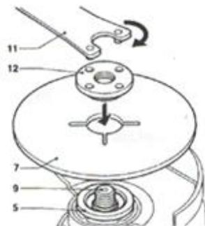
3. Установите шлифовальный или отрезной диск (7) на внутренний фланец (5);
