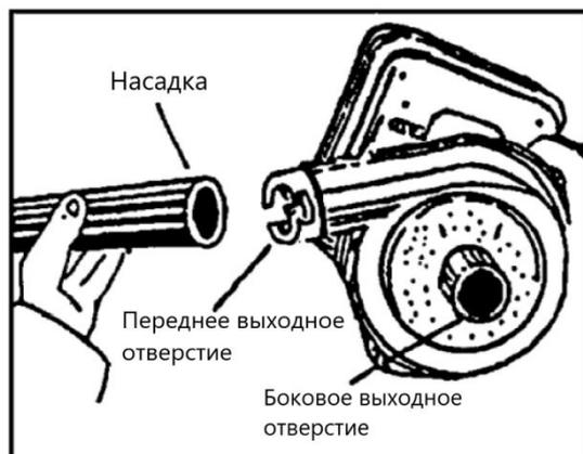
2. Для всасывания присоедините сопло к боковому отверстию и пылесборный мешок к переднему выходному отверстию.
