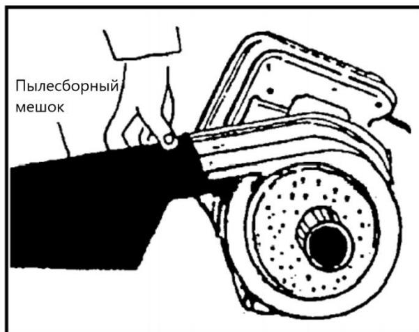
3. Когда мешок для пыли заполнится, снимите мешок и опустошите его.
