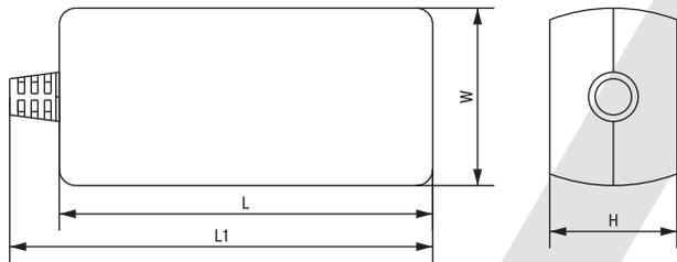
Рисунок 1 – Колодка удлинителя
